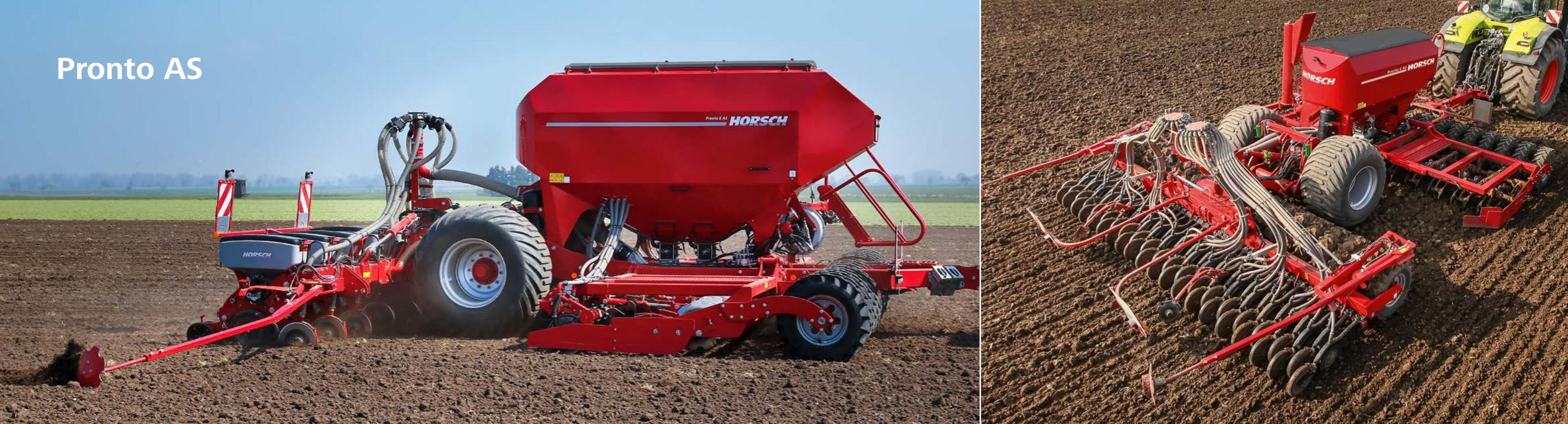
Pronto 6 AS permite utilizarea buncărului de semințe cu elemente frontale, în combinație cu ansamblul TurboDisc-tăvălug cu roți de cauciuc sau cu Maestro RV.
