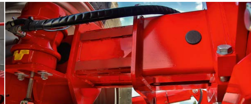
Ax telescopic (standard) Lățime compactă de transport; reduce presiunea pe urmele tractorului
