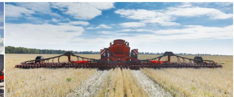
Transfer hidraulic al greutateii de la buncărul de semințe la brăzdare: Presiune ridicată a brăzdarelor pe întreaga lățime de lucru.
