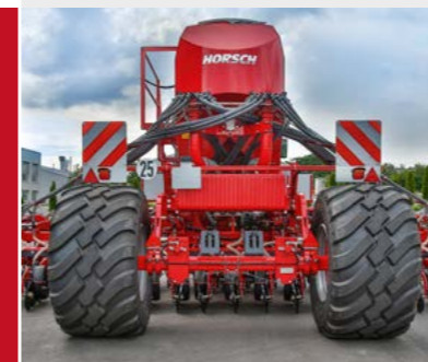
Opțional: anvelope 710/50–26.5 pentru amprentă mare la sol
