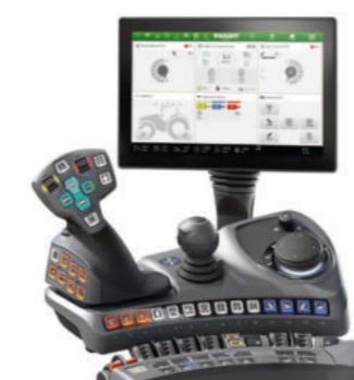
Setarea 1 la varianta Profi / Setarea 1 la varianta Profi+ • Manetă în cruce • Două perechi de balansiere (module liniare) pentru acționarea supapelor hidraulice
