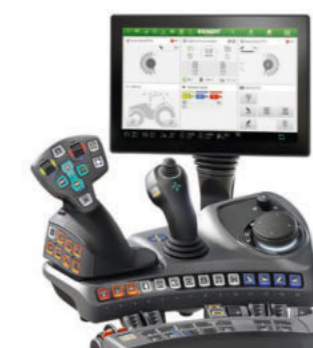
Setarea 2 la varianta Power+ • Joystick 3L • O pereche de balansiere (modul liniar) pentru acționarea supapelor hidraulice
