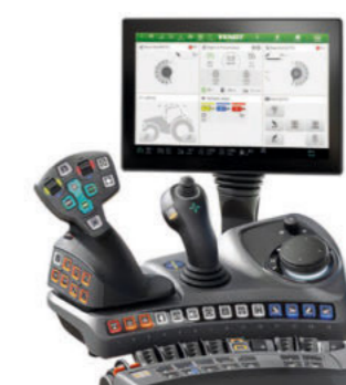
Setarea 2 la varianta Profi / Setarea 2 la varianta Profi+ • Joystick 3L • Două perechi de balansiere (module liniare) pentru acționarea supapelor hidraulice
