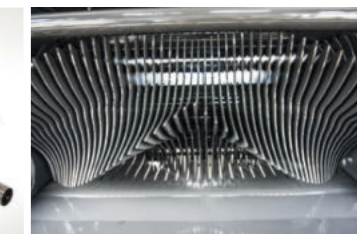
Rotor XtraCut25 - Cu heder: până la 25 de cuțițe
