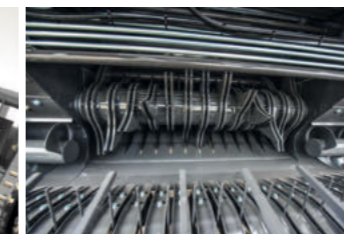
Rotor XtraCut13 (Distanță pereche de degete: 90 mm) - Fără heder (în echipare standard) - Cu heder: până la 13 cuțițe
