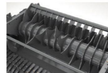
Rotor de transport fără heder
